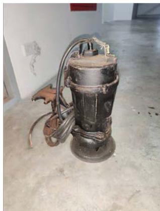
รูปที่ 2-14 อะไหล่สำรองของระบบบำบัดน้ำเสีย
